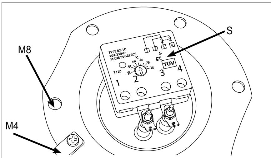
4. Συνδέουμε το μαύρο καλώδιο (φάση) στην επαφή 1 του θερμοστάτη και το μπλε (ουδέτερος) στην επαφή 4 του θερμοστάτη. Το κίτρινο (γείωση) βιδώνεται στο βιδάκι M4 που βρίσκεται πάνω στην αντίσταση με την ένδειξη της γείωσης.
