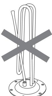
**Προσοχή:** Το κυάθιο του θερμοστάτη της αντίστασης να μην έχει καμμία παραμόρφωση ή στράβωμα. Κατά την τοποθέτηση πρέπει να βρίσκεται στο κάτω μέρος της αντίστασης **εκτός** από το κυάθιο του θερμοστάτη της αντίστασης του θερμοσίφωνα των 10L (βλ. σχήμα).
