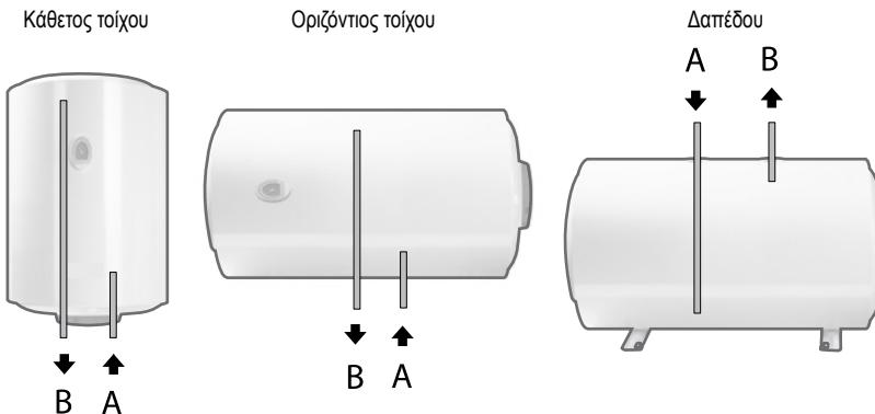
Όταν συνδέετε τον εναλλάκτη θερμότητας του θερμοσίφωνα με δίκτυο νερού θέρμανσης φροντίστε να μην **ξεπερνά** η θερμοκρασία του ζεστού νερού προσαγωγής τους  $80^{\circ}\text{C}$  έτσι ώστε να μην ενεργοποιείται ο θερμικός διακόπτης ασφαλείας.
